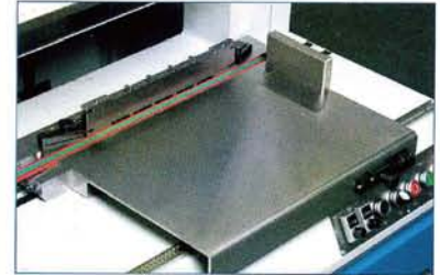
滑动台扩展了PB16钻孔机的应用范围
